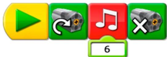
Мотор вращается по часовой стрелке, воспроизводится заданный звук, затем мотор выключается
