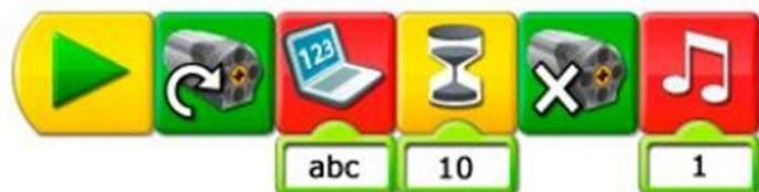
Программа вращает мотор, выводит на экран «abc», ждет 1 секунду, останавливает мотор и проигрывает мелодию.
