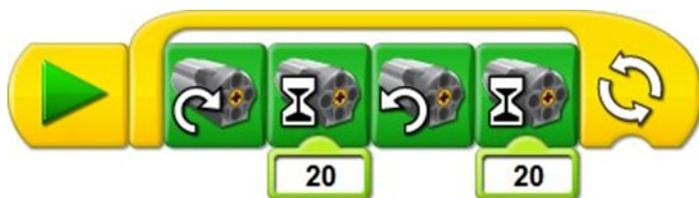
Программа запускает мотор по часовой стрелке на 2 секунды, после чего программа запускает мотор в обратном направлении и вращает его так же 2 секунды. Данный алгоритм будет выполняться бесконечное количество раз (так как программа заключена в цикл), пока пользователь не остановит программу.
